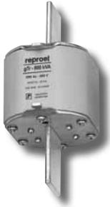
Fusibles tipo NH clase gTr protegen transformadores contra sobrecargas y cortocircuitos, sin limitar su capacidad de carga, además soportan las corrientes de arranque en frío y en calientes típicas de los sistemas de distribución.
